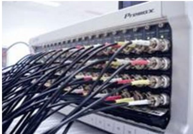
同时配有强大的数据后处理和自动报告生成功能，实现您所需要的数据处理与分析 and 测试报告。MI-80XX 系列数据采集与分析仪单台系统最高可扩展至 64 个输入通道，对于需要更多采集通道要求的测试，可通过千兆网构建多台系统，最大可扩展至 1024 个通道。
